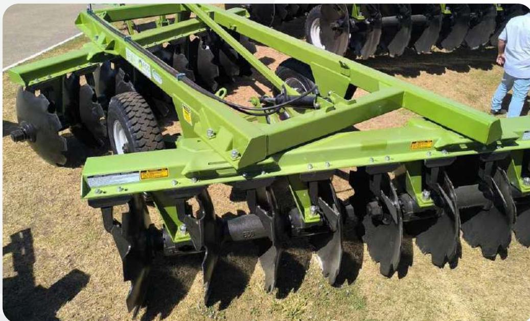
A **Grade Super Pesada Compacta** foi projetada para ser utilizada no primeiro estágio de preparação do solo, abertura de novas áreas e/ou erradicação de cana-de-açúcar. Devido as condições severas e pesadas de trabalho as quais são destinadas, este modelo oferece ampla regulagem. O equipamento possui barra estabilizadora e conjunto de rodado com 2 Pneus 900x20 usados em todos os modelos, acionado via comando hidráulico direto da cabine do trator (controle remoto).
