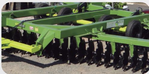
A **Grade Intermediária Modelo SGA I** destaca-se pela sua estrutura totalmente reforçada, proporcionando maior vida útil ao produto, onde permite efetuar sua atividade com alto desempenho em diversas condições de solo. Indicada para preparo em terrenos anteriormente cultivados com cereais e/ou para utilização pós gradagem pesada em novas áreas ou canaviais, fazendo este trabalho com qualidade e perfeição requeridas pelos agricultores de diversas culturas.
