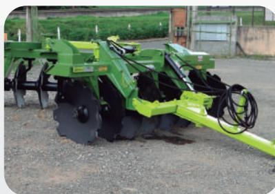
A **Grade Super Pesada com Abertura Mecânica ou Hidráulica (GSP\_H)** foi projetada para ser utilizada no primeiro estágio da preparação do solo, abertura de novas áreas e/ou erradicação de cana-de-açúcar. Devido às condições severas e pesadas de trabalho as quais são destinadas, este modelo oferece ampla regulagem para ajuste de ângulo de corte da grade com cilindro hidráulico ou mecânico.
