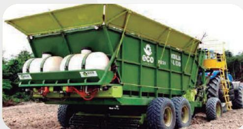
A **Plantadora Modullus P EcoAgrícola** foi desenvolvida para atender o processo de mecanização do plantio de cana-de-açúcar, o equipamento destaca-se pela sua funcionalidade e alto desempenho operacional. Visando a otimização e redução de custos no plantio, o equipamento realiza as operações do plantio da cultura de uma só vez: abertura dos sulcos, distribuição do adubo, das mudas, aplica o inseticida, faz a cobertura dos sulcos e por último o acabamento do solo.
