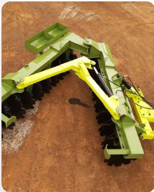
A **Grade Aradora Pesada de Arrasto com Abertura Mecânica ou Hidráulica (GAPM\_H)** foi projetada para ser utilizada no preparo de diferentes tipos de solo, previamente cultivados ou abertura de novas terras destinadas ao plantio, fazendo este trabalho com qualidade e perfeição requeridas pelos agricultores de diversas culturas. Este modelo oferece ampla regulagem para ajuste de ângulo de corte da grade, com cilindro hidráulico e mecânico.
