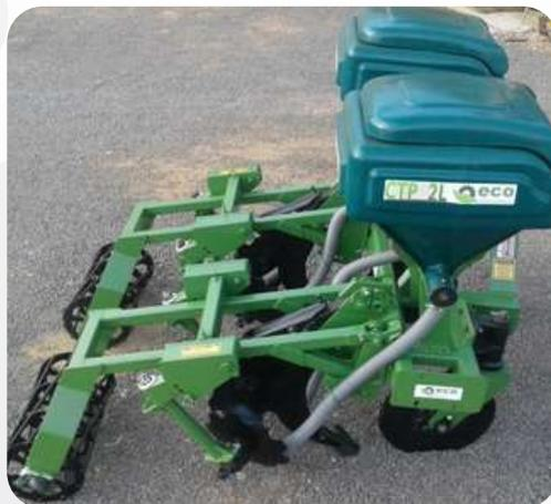
O equipamento **CTP - Cultivador Adubador EcoAgrícola** realiza simultaneamente várias operações, como a subsolagem, o destorroamento, a adubação e o corte da palhada (cultivo nas soqueiras), podendo ser utilizado tanto na cana crua quanto na cana queimada (ver kit's opcionais).
