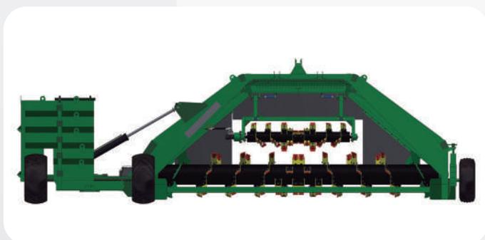
Túnel com 5 metros de largura, possibilitando o trabalho com leiras em dimensões aproximadas de 5,0m x 1,80m, resultando em maior produtividade. Saída em ângulo para melhor vazão para o material revolvido.
