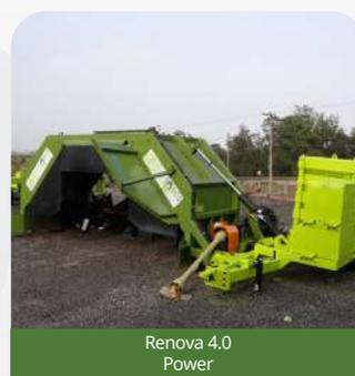
Túnel 4,0 metros, possibilidade de trabalhar com leiras em dimensões aproximadas de 4,0m L x 1,50m A. Tração por trator 4x4 com potência sugerida acima de 90 a 120cv (variável para + ou para - de acordo com as condições do pátio), equipado com super-reductor e com 01 comando hidráulico (cilindro). Opcional kit aletas MAXXCORTE: especialmente desenhadas para aumentar o desempenho e melhorar a performance do equipamento. Opcional: TDP 540RPM ou 1.000RPM.
